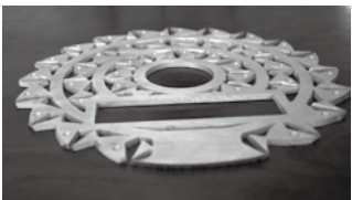
切り出しの際は、型が抜けるよう切り口に勾配をつけている。
