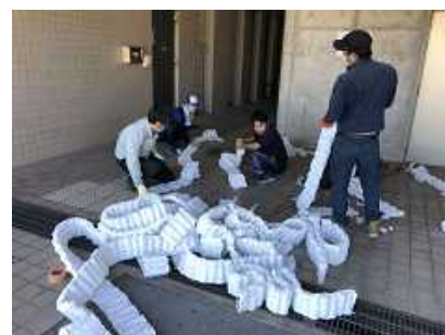
ソファ・マットレスを分解し鉄（リサイクル）と可燃ごみに分類し処分します ↑
