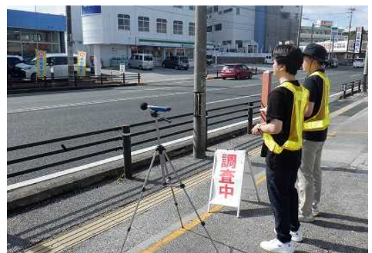
▲騒音測定の様子
