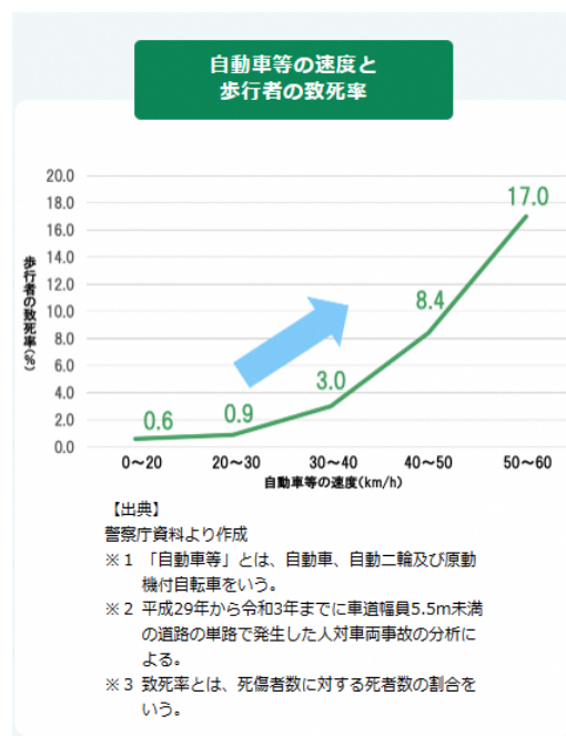
図 12 速度抑制効果及び走行速度による歩行者の死亡率
