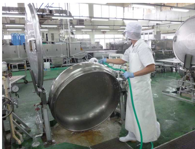
調理後の釜の洗浄作業
