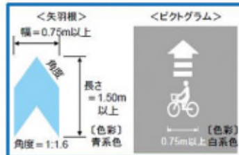
<車道混在とする場合に併用する路面表示の標準仕様>
